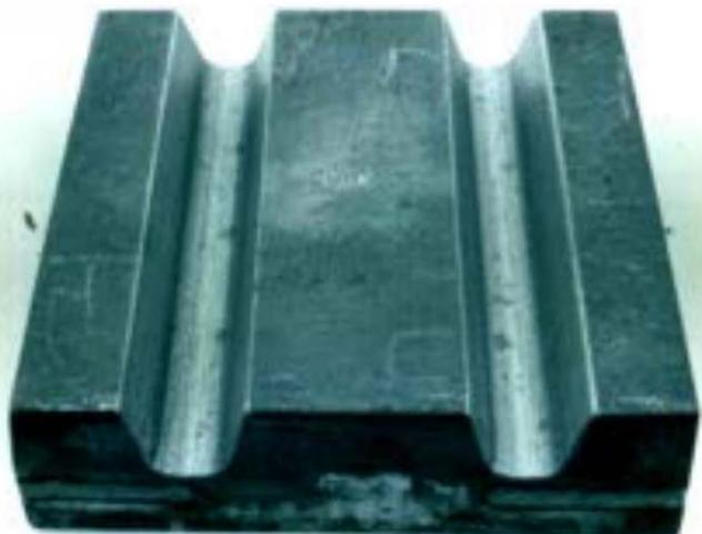
При этом используется стандартное оборудование для ручной сварки и нет необходимости в сжатом воздухе, горючем газе или специальном инструменте
