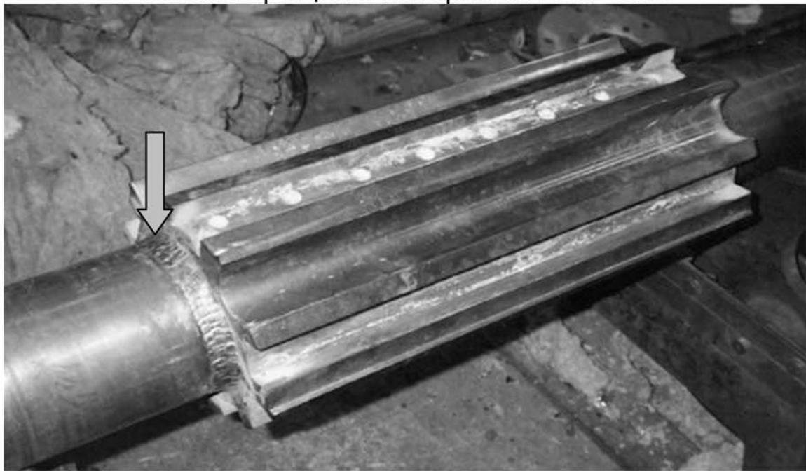
Наплавка посадочных мест под подшипники материалом UTP 65D
