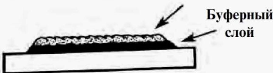
Для наплавки таких буферных слоев предпочтительней использовать электроды UTP 65D.
