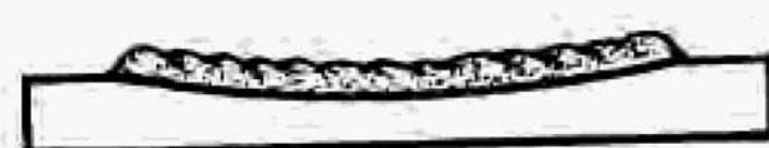
Это может вызвать растрескивание наплавленного металла. Чтобы избежать этого, на исходную поверхность перед упрочняющей наплавкой наносится буферный слой.
