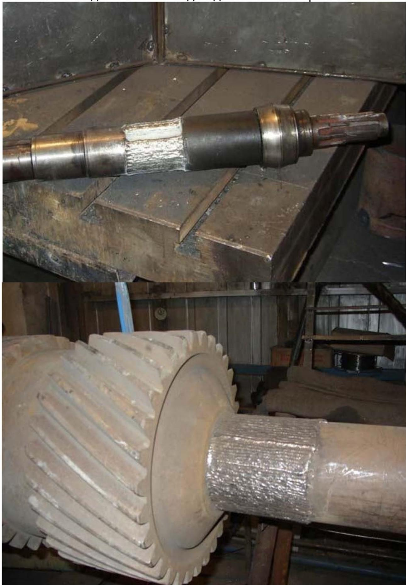
Ремонт трещины материалом UTP 65D
