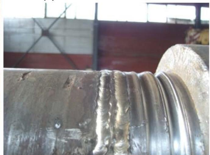
Ремонт барабанов шахтоподъемных установок
