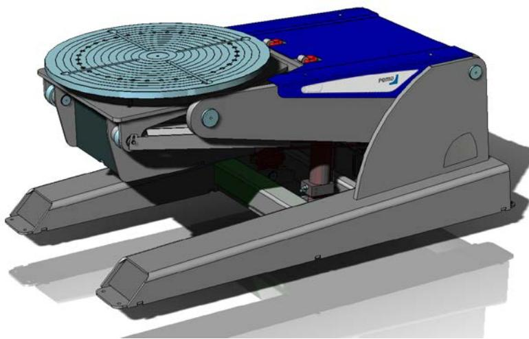
Манипуляторы серии PEMA APS Skymaster – это оптимальное решение задачи кантования тяжелых заготовок сложной формы во время сварки. Оптимальное положение заготовки достигается изменением высоты, угла наклона и скорости вращения и полностью регулируются с пульта дистанционного управления, имеющего цифровую индикацию.
