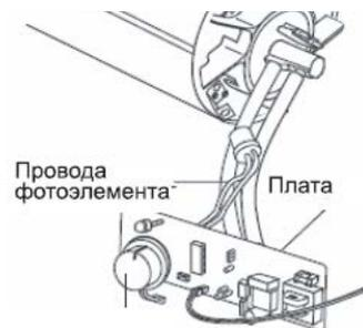
Рис. 19 Установка фотоэлемента
