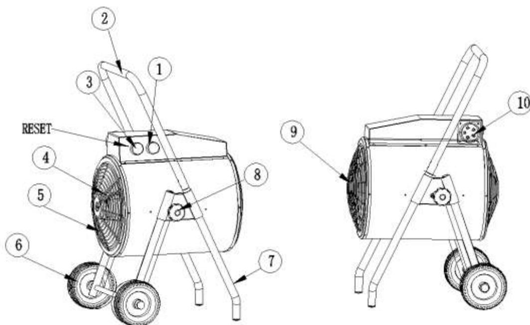
(1)выключатель (2) ручка (3) термостат (4) мотор (5) задняя крышка (6) колеса
