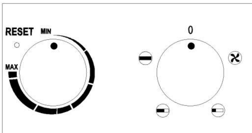
Четырехуровневый поворотный выключатель с 5ю позициями – 1 уровень – вентилятор; второй уровень – мощность 5 кВт, 3 уровень – мощность 10 кВт, 4 уровень – это полная мощность 15 кВт
