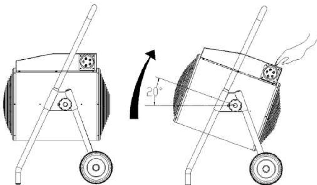
Во время работы, можно увеличить угол наклона, самое большее на 20 градусов. Вначале подкрутите регулировки с обеих сторон стальных ножек и слегка надавите на заднюю часть
