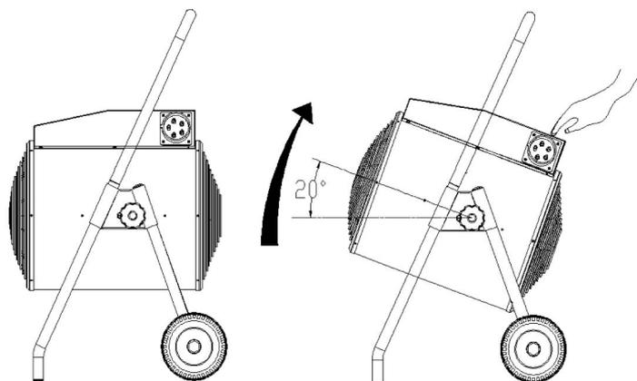
Во время работы, можно увеличить угол наклона, самое большее на 20 градусов. Вначале подкрутите регулировки с обеих сторон стальных ножек и слегка надавите на заднюю часть аппарата, он начнет наклоняться. Отрегулируйте угол наклона на нужную позицию, чтобы поток воздуха был направлен немного вверх. Если вам необходимо вернуть направление потока воздуха в горизонтальное положение, постепенно нажмите переднюю верхнюю крышку аппарата вниз.
