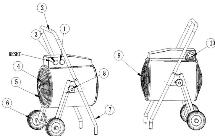
(1)выключатель (2) ручка (3) термостат (4) мотор (5) задняя крышка (6) колеса
