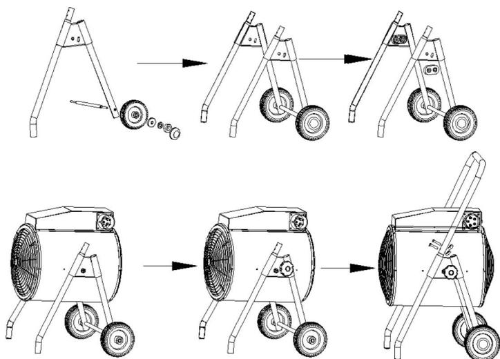
1. Установите колеса на ось при помощи Ø8 пружинной шайбы, Ø8 плоской шайбы, М8 гайки, зафиксируйте диск колеса и шину на него
