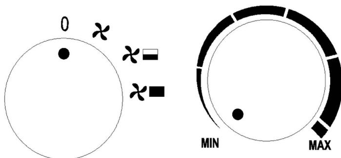
Трехуровневый поворотный выключатель с 4мя позициями – 1 уровень – вентилятор; второй уровень – мощность 11 кВт, 3 уровень – это полная мощность 22 кВт
