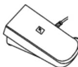
выходной ток может регулироваться от минимального до максимального значения (задается через set-up) изменением силы давления на поверхность педали. Микропереключатель обеспечивает сигнал начала сварки при минимальной силе давления на педаль.
