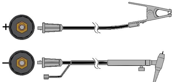
Подключите горелку к терминалу (-), а кабель на деталь подключите к терминалу (+), расположенных на аппарате. Вставьте сварочный разъем, выровняв его так, чтобы выступ ключа входил в ответный паз и поверните его на  $\frac{1}{4}$  оборота по часовой стрелке. В заключение подготовки присоедините газовый шланг к регулятору на баллоне Аргоном.
