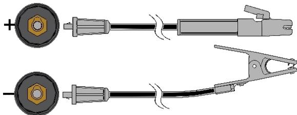
Подключите электродный кабель к терминалу обозначенному как (+), а кабель на деталь к терминалу (-). Вставьте сварочный разъем, выровняв его так чтобы выступ ключа входил в ответный паз и поверните его на  $\frac{1}{4}$  оборота по часовой стрелке.
