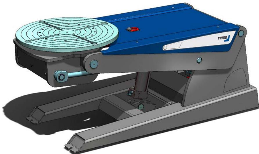
*Манипуляторы серии PEMA APS Skymaster – это оптимальное решение задачи кантования тяжелых заготовок сложной формы во время сварки. Оптимальное положение заготовки достигается изменением высоты, угла наклона и скорости вращения и полностью регулируются с пульта дистанционного управления, имеющего цифровую индикацию. Производятся манипуляторы Skymaster с грузоподъемностью от 250 до 35000 кг.*
