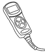
Anordningen RC 200 är en fjärrstyrning, som medger visning och inställning av alla disponibla parametrar på styrpanelen till den generator som den är kopplad till.
