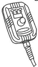
De RC 100 is een afstandbediening om de lasstroom en lasspanning mee weer te geven en te regelen.
